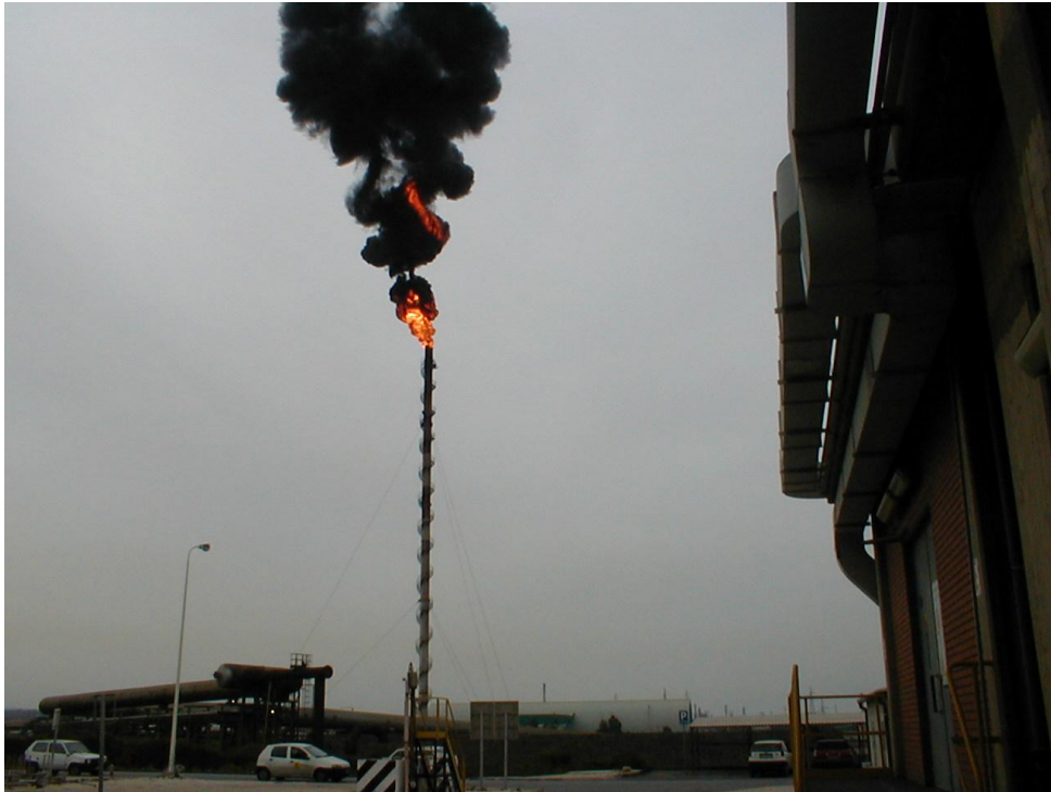
Figura 150: Formazione di un pennacchio in una torcia di raffineria
