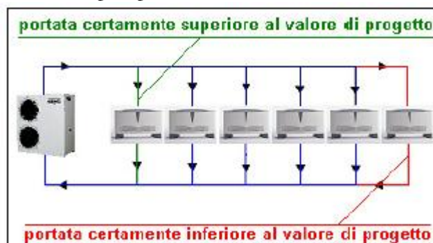
Figura 51: Esempio di rete a ritorno diretto con equilibratura dei circuiti
