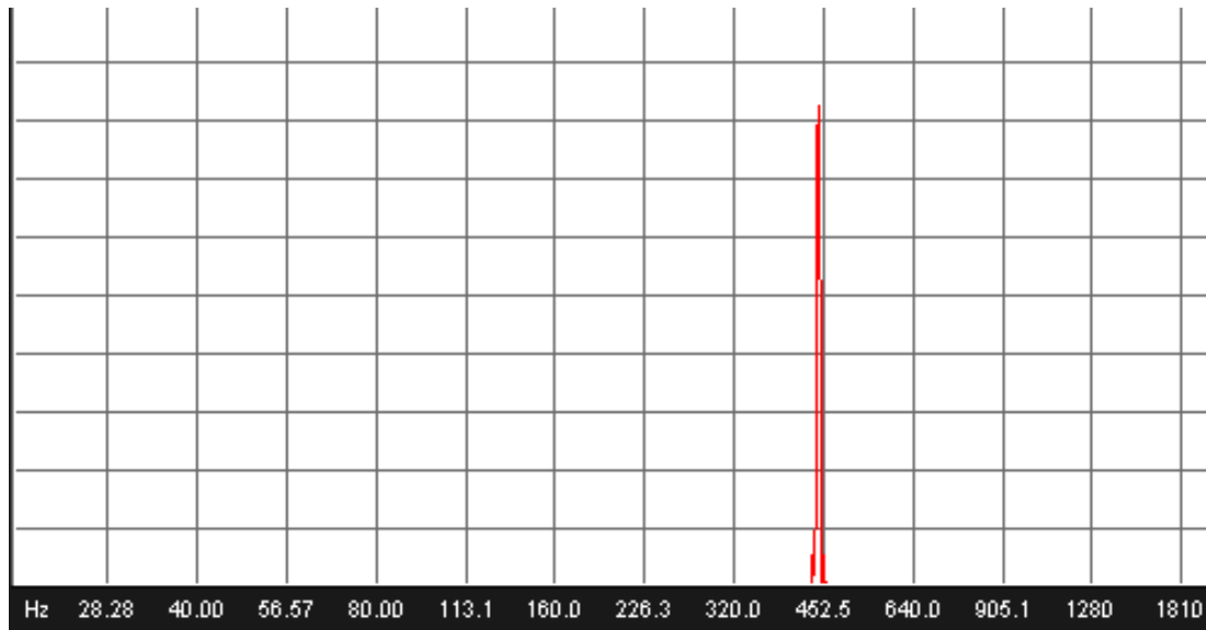
Figura 28: Spettro FFT del suono puro a 452 Hz
