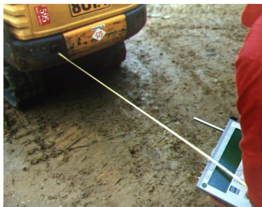
Figura 100: Modalità di misura dei livelli di potenza
