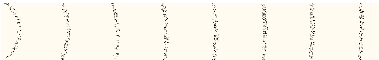
Figura 7: Esempio di propagazione di onde acustiche: inizialmente sferiche e poi piane a grandi distanze
