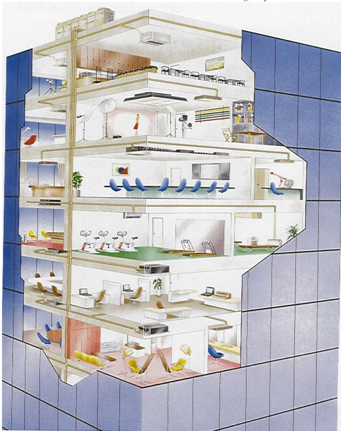
Figura 80: Schema di installazione di sistemi split in un edificio
