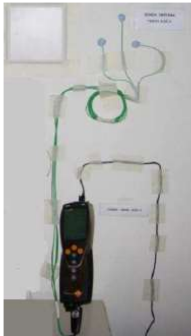
Figura 90: Posizionamento delle sonde a contatto
