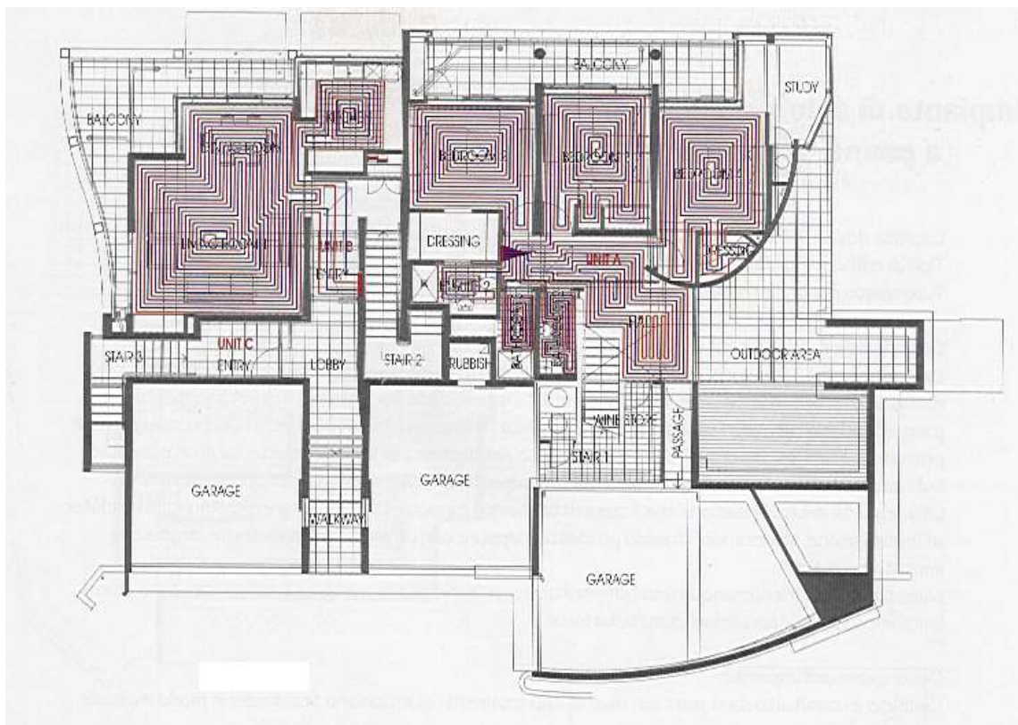
Figura 315: Esempio di impianti radianti in appartamenti
