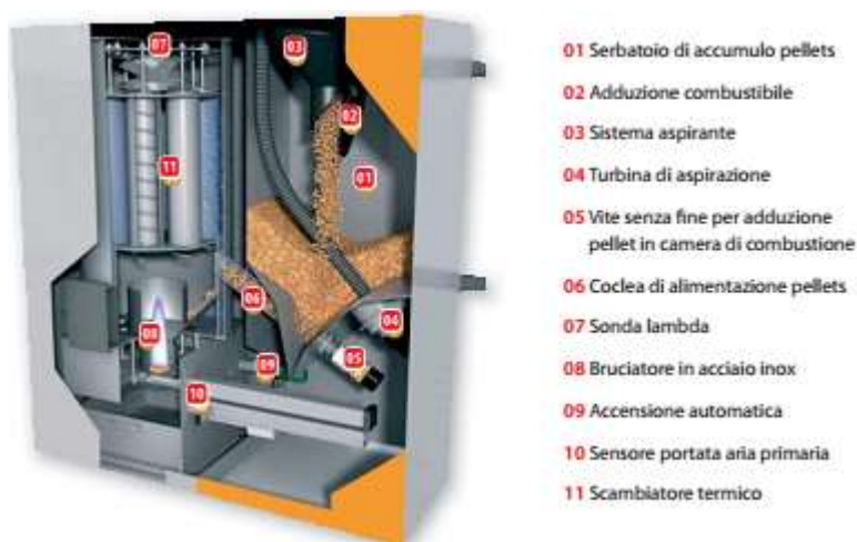
Figura 203: Funzionamento di una caldaia a pellets
