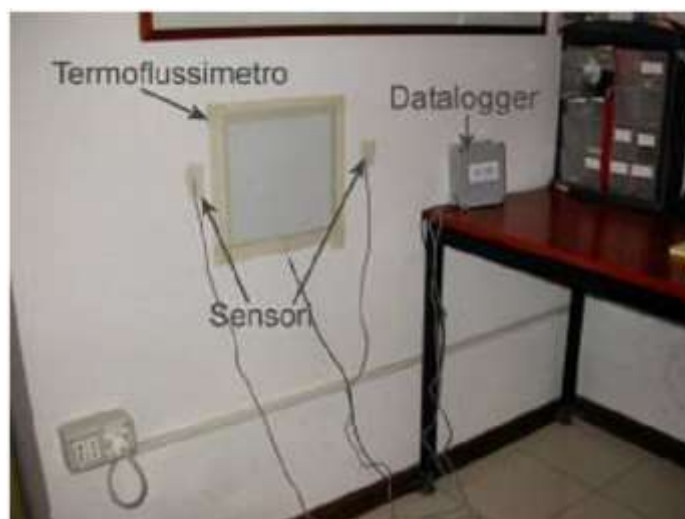
Figura 92: esempio di applicazione delle sonde per il termo flussimetro
