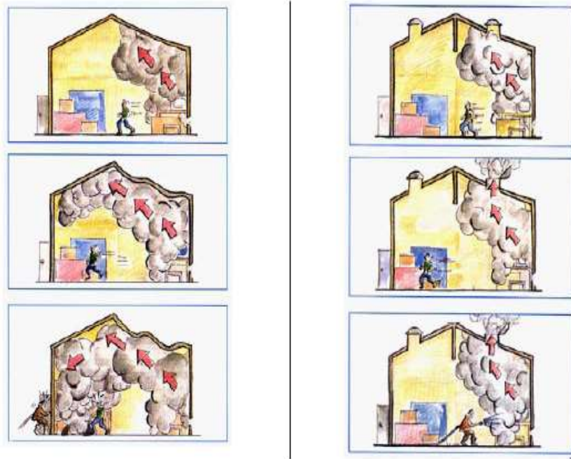
Figura 263: efficacia degli evacuatori di fumo e di calore
