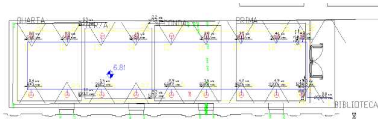
Figura 258: Rete sprinkler, in pianta, per una biblioteca
