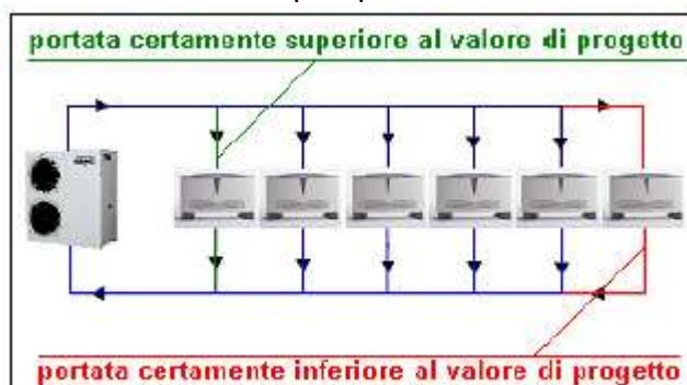
Figura 117: Esempio di rete a ritorno diretto con equilibratura dei circuiti
